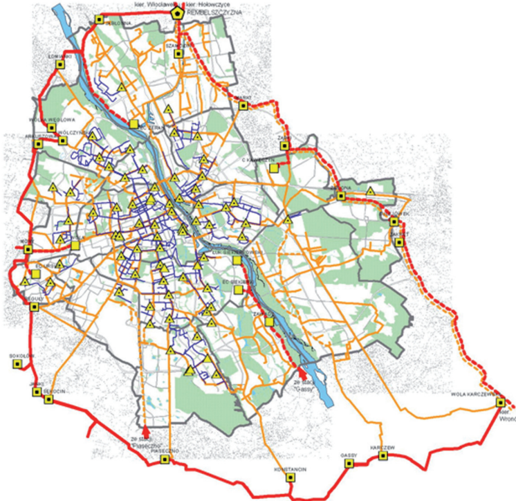
Ryc. 8. Rozwój systemów infrastruktury technicznej – gazownictwo
